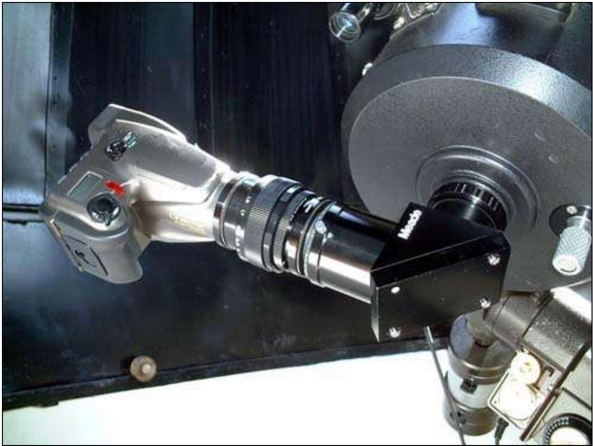
Figura 10- Sistema de projecção afocal. Telescópio Schmidt-Cassegrain 200 mm f/10 , objectiva 80 mm 1:2.8 e Olympus Camedia C-1400L . Pedro Ré (2001).
