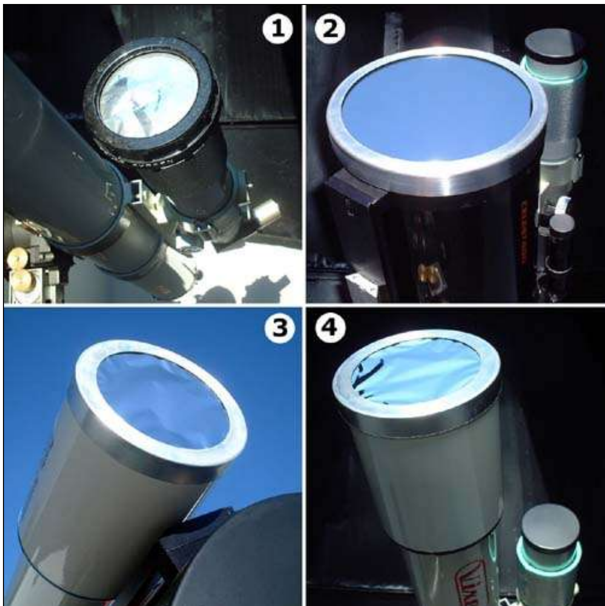
Figura 12- Filtros frontais para observação e fotografia do Sol: 1- Mylar (Solar skreen) , telescópio Takahashi FS60 ; 2- Thousand Oaks , telescópio C8 , 3- Baader Planetarium , telescópio Takahashi FS102 , 4- Baader Planetarium , telescópio Vixen 102 . Pedro Ré (2001).
