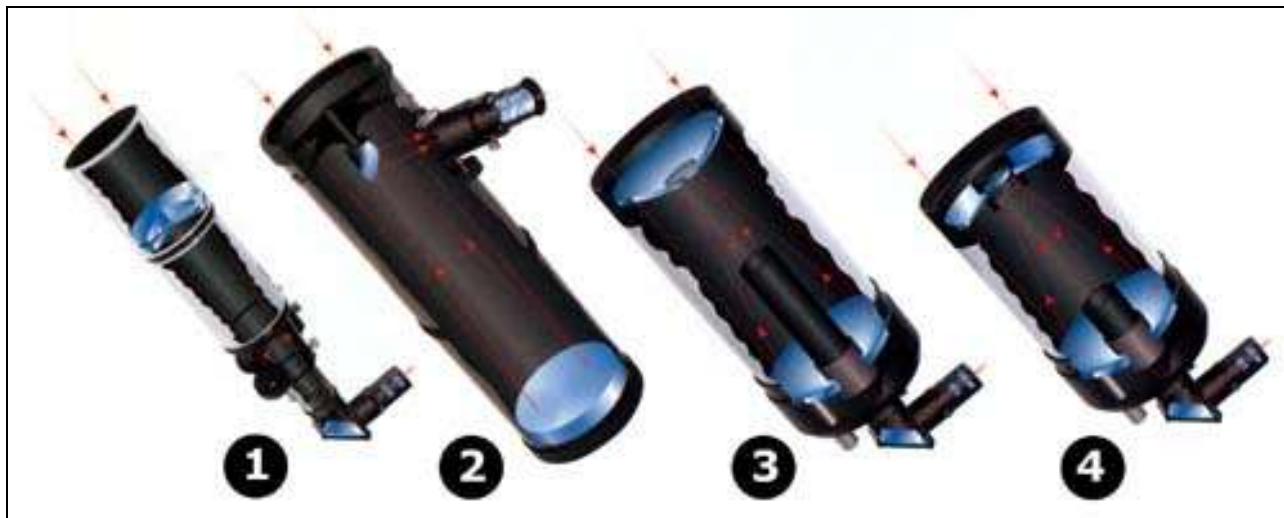
Figura 7- Principais tipos de telescópios: 1- Telescópio refractor; 2- telescópio reflector; 3- telescópio catadióptrico (Maksutov-Cassegrain); 4- Telescópio catadióptrico (Schmidt-Cassegrain).
