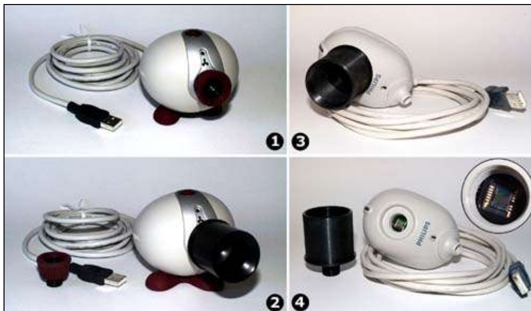
Figura 18- Adaptação de duas Webcams para astrofotografia. 1- Philips Vesta Pro não modificada; 2- Vesta Pro munida de um adaptador standard 1 ¼"; 3 e 4- Toucam Pro modificada. Pedro Ré (2002).
