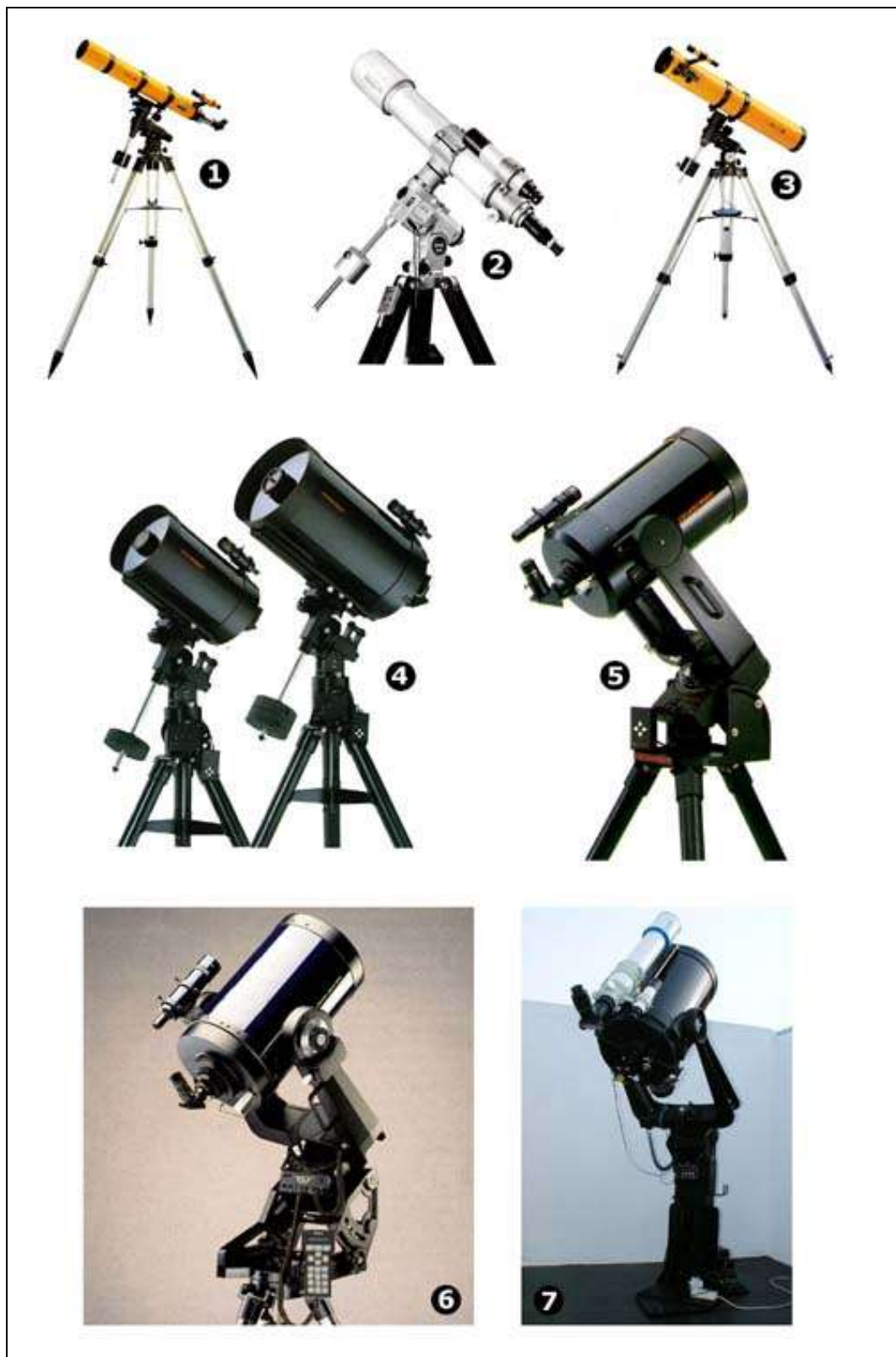
Figura 8- Exemplos de algumas montagens equatoriais fotográficas: 1- Montagem alemã, refractor acromático Konus 100 f/10 ; 2- Montagem alemã EM10, refractor apocromático Takahashi FS102; 3- Montagem alemã, reflector Konus 114 mm f/8 ; 4- Montagens alemãs CM1400 e CM1100, telescópios Schmidt-Cassegrain C11 e C14; 5- Montagem de garfo, telescópio Schmidt-Cassegrain C8; 6- Montagem de garfo, Meade LX200 10"; 6- Montagem de garfo, C14 e refractor apocromático Takahashi FS102. Pedro Ré (2001).
