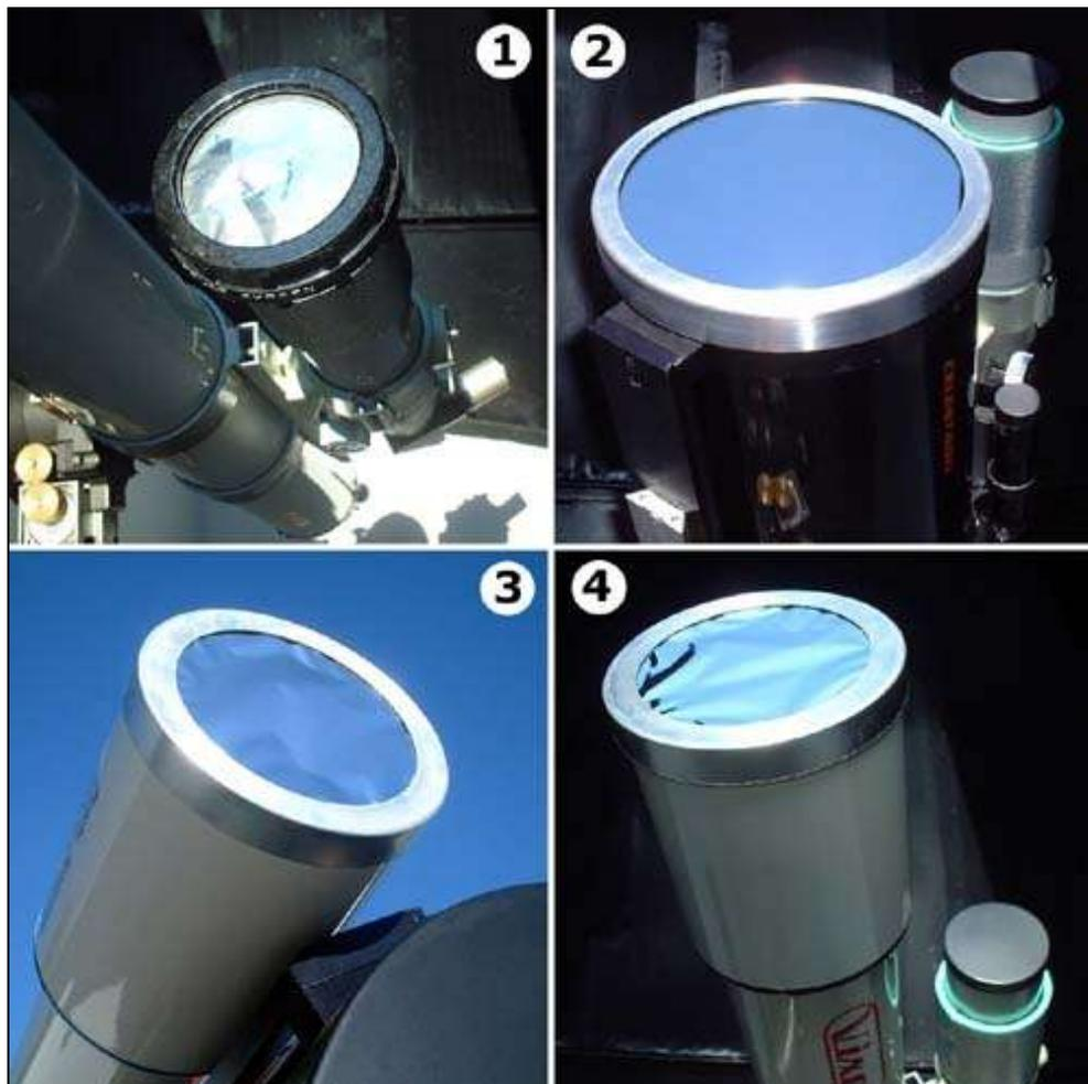
Figura 6- Filtros frontais para observação e fotografia do Sol: 1- *Mylar (Solar skreen)*, telescópio *Takahashi FS60*; 2- *Thousand Oaks*, telescópio *C8*, 3- *Baader Planetarium*, telescópio *Takahashi FS102*, 4- *Baader Planetarium*, telescópio *Vixen 102*. Pedro Ré (2001).
