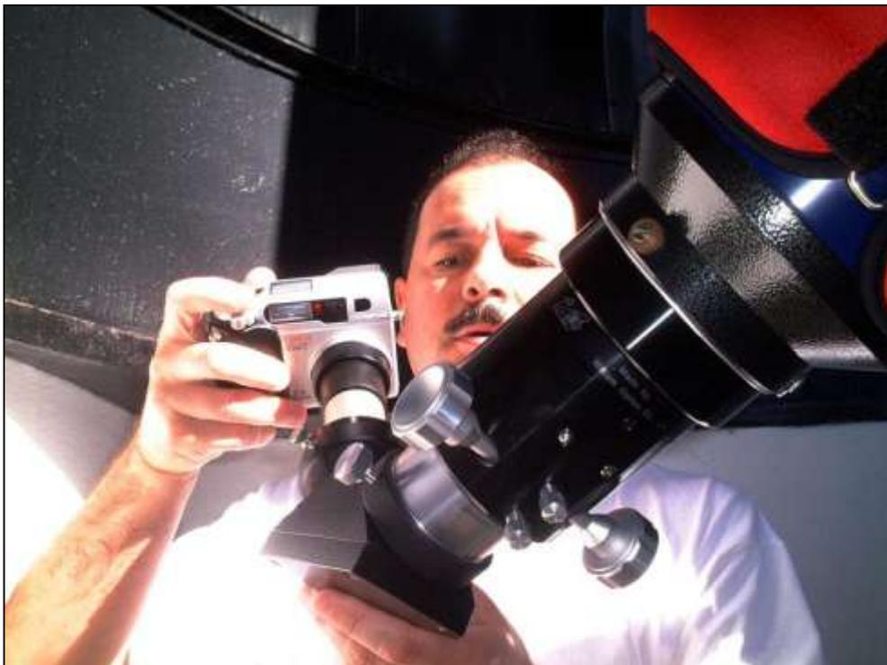
Figura 4- Fotografia por projecção afocal. Telescópio refractor 150 mm  $f/8$ , ocular Vixen 26 mm e *Olympus Camedia c2000z*. Pedro Ré (2003).
