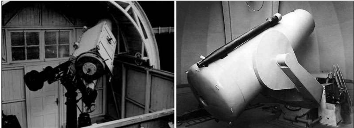
Figura 4- Primeira câmara de Schmidt construída em 1930 e câmara de Schmidt Samuel Oschin (48") do observatório do Monte Palomar (1948).
