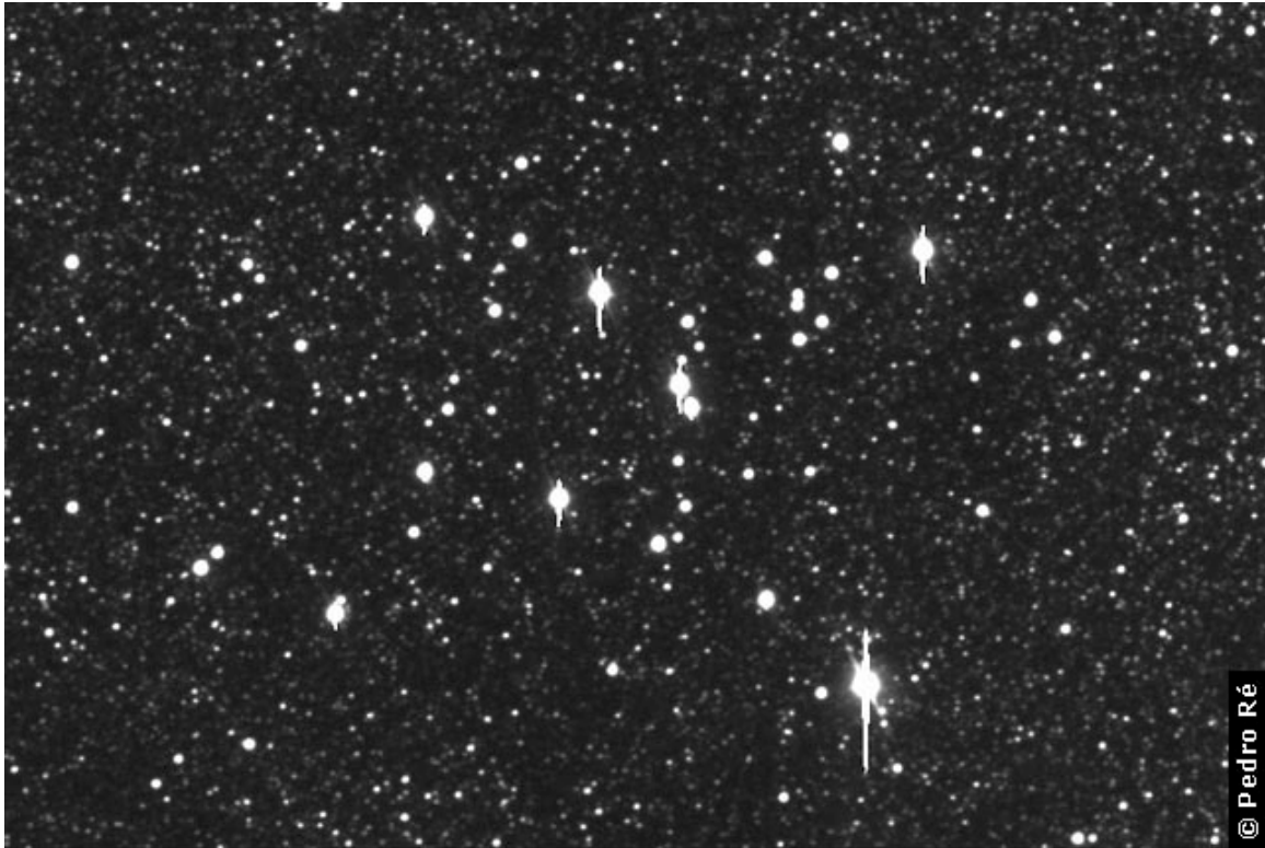
Figura 3- estrelas saturadas (sensor CCD s/ "antiblooming"). M7 Takahashi FS102 + ST-7.
