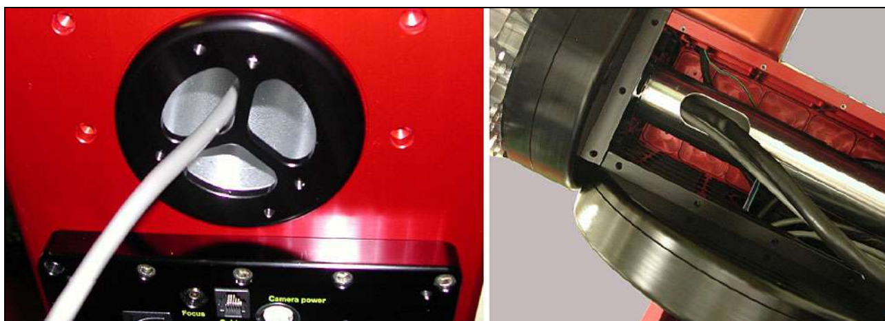
Figura 15- Sistema de passagem de cabos adicionais pelo interior da montagem.
