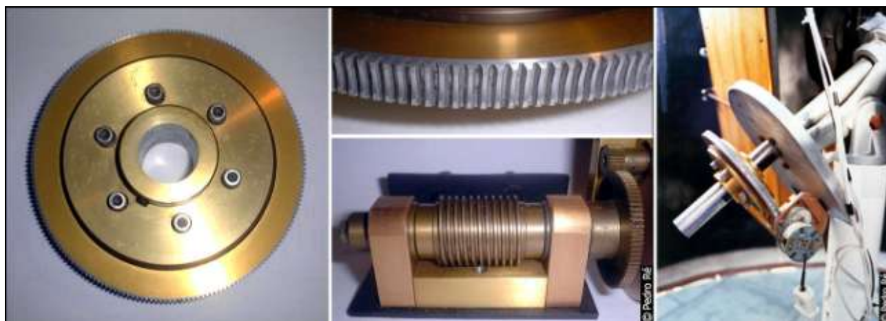
Figura 4- Roda dentada de 15 cm de diâmetro e sem fim (Byers). Montagem equatorial alemã (telescópio reflector 222 mm f/5.8): visível a roda dentada Byers (movimento horário). Pedro Ré (1985).
