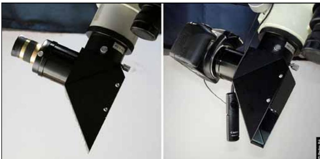
Figura 6- Prisma de Herschel Solarvue 2 (Astro Engineering) instalado num telescópio refractor apocromático Takahashi FS128 F/8.1 (observação visual e fotográfica – DSLR Canon 350D). Pedro Ré (2007).
