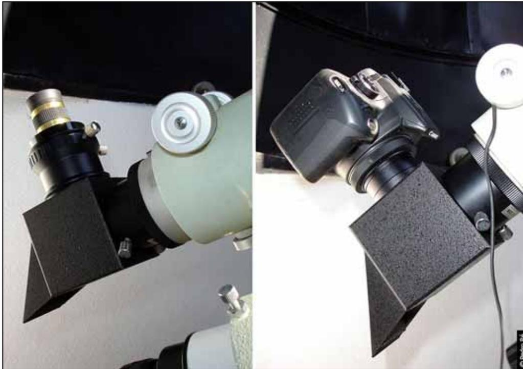
Figura 5- Prisma de Herschel Baader Planetarium instalado num telescópio refractor apocromático Takahashi FS128 F/8.1 (observação visual e fotográfica – DSLR Canon 350D). Pedro Ré (2007).
