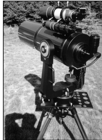
La lunette courte de \phi 80\text{mm} Atlas de Bertrand Laville, montée sur le LX200 de \phi 254\text{mm} (photos de l'auteur).
