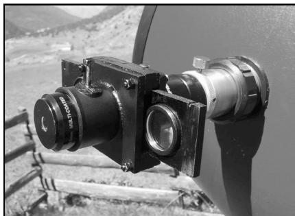
Porte-filtre en place au foyer d'un Newton \phi 445mm avec barre de translation et ses filtres en place, l'oculaire dans son logement et la Barlow placée juste devant.
