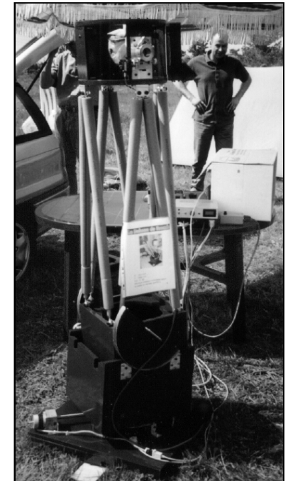
Rustique et technologique à la fois, le Dobson de ø253mm de Francis TISSERAND est asservi grâce au système développé par Mel BARTELS (logiciel gratuit): Goto et suivi identique à un instrument du commerce.
