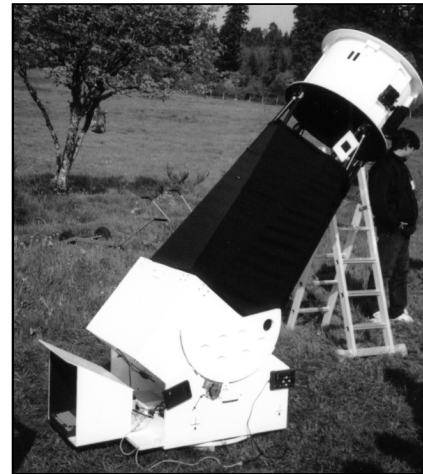
Le superbe Dobson de ø500mm d'Olivier RUAU asservi par le micro-ordinateur portable dans son abri sous le barillet via le système Dob-Driver II.
