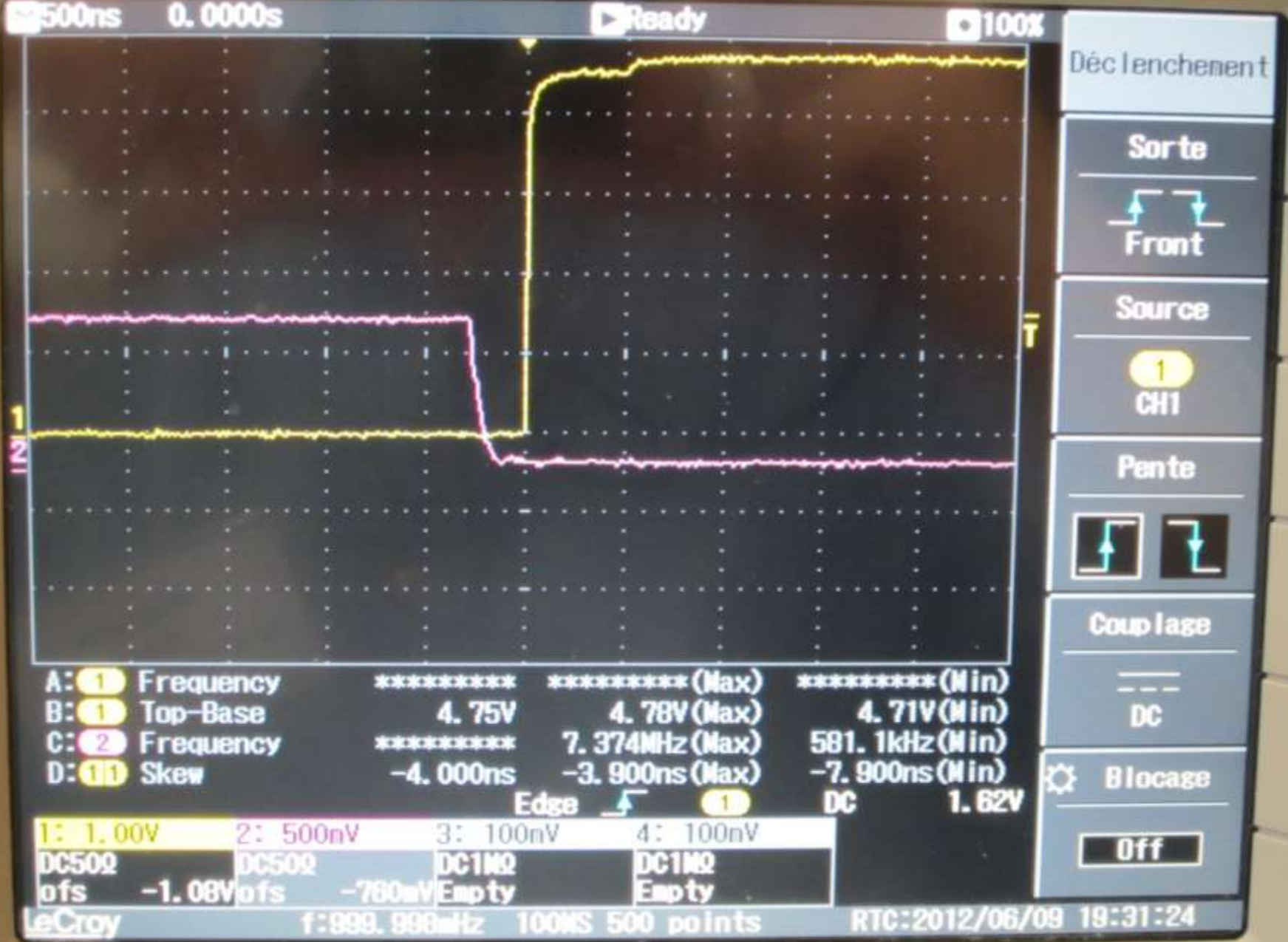
Pps GPS Garmin en avance de 300ns-184ns=116ns sur UTCOP
