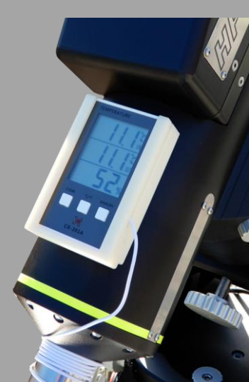
Thermomètre digital avec support 3D sur la monture 10 Micron GM 2000 HPS
