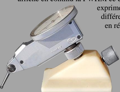
Comparateur (Pupitas) avec support 3D monté sur porte oculaire avec adhésif (Fig.7)
