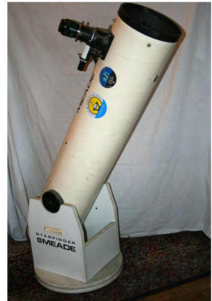
Fig.2: Telescópio Newtoniano de 8 polegadas numa montagem Dobsoniana.
