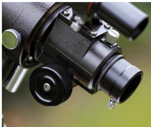
Le porte-oculaire peut être équipé d'une sortie en 31,75 mm. Disposant d'une crémaillère très classique, il apparaît suffisamment précis pour permettre d'obtenir assez facilement la mise au point.
