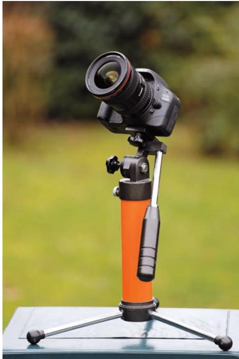
◀ Le pied colonne de table est stable et peut servir de pied d'appont pour un appareil photo équipé de son objectif, à des fins de prises de vues en longue pose (filés d'étoiles). Notez la présence de la poignée de manipulation de la monture, qui fait aussi office de contrepois.
