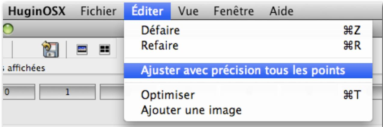
Cela permet de positionner les points de contrôle précisément, et comme ce sont eux qui déterminent la précision de l'assemblage, c'est essentiel.
