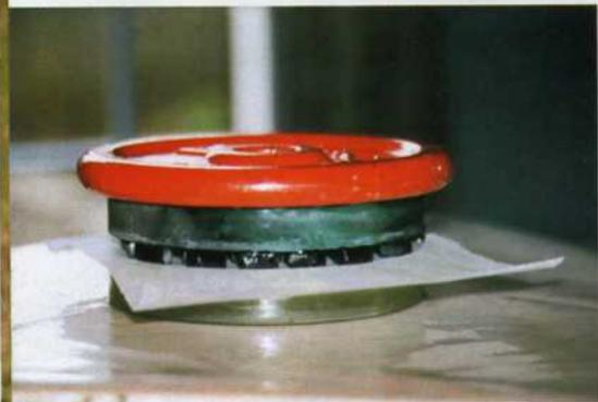
**Mise en pression du polissoir : "La poix étant tendre, il suffit de mettre en pression le polissoir pour qu'il ait le même rayon de courbure que celui du miroir"**
