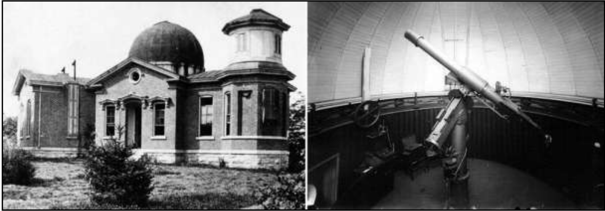
Figura 3- Observatório Dyer da Univerdidade de Vanderbilt e refractor Cooke de 150 mm de abertura.
