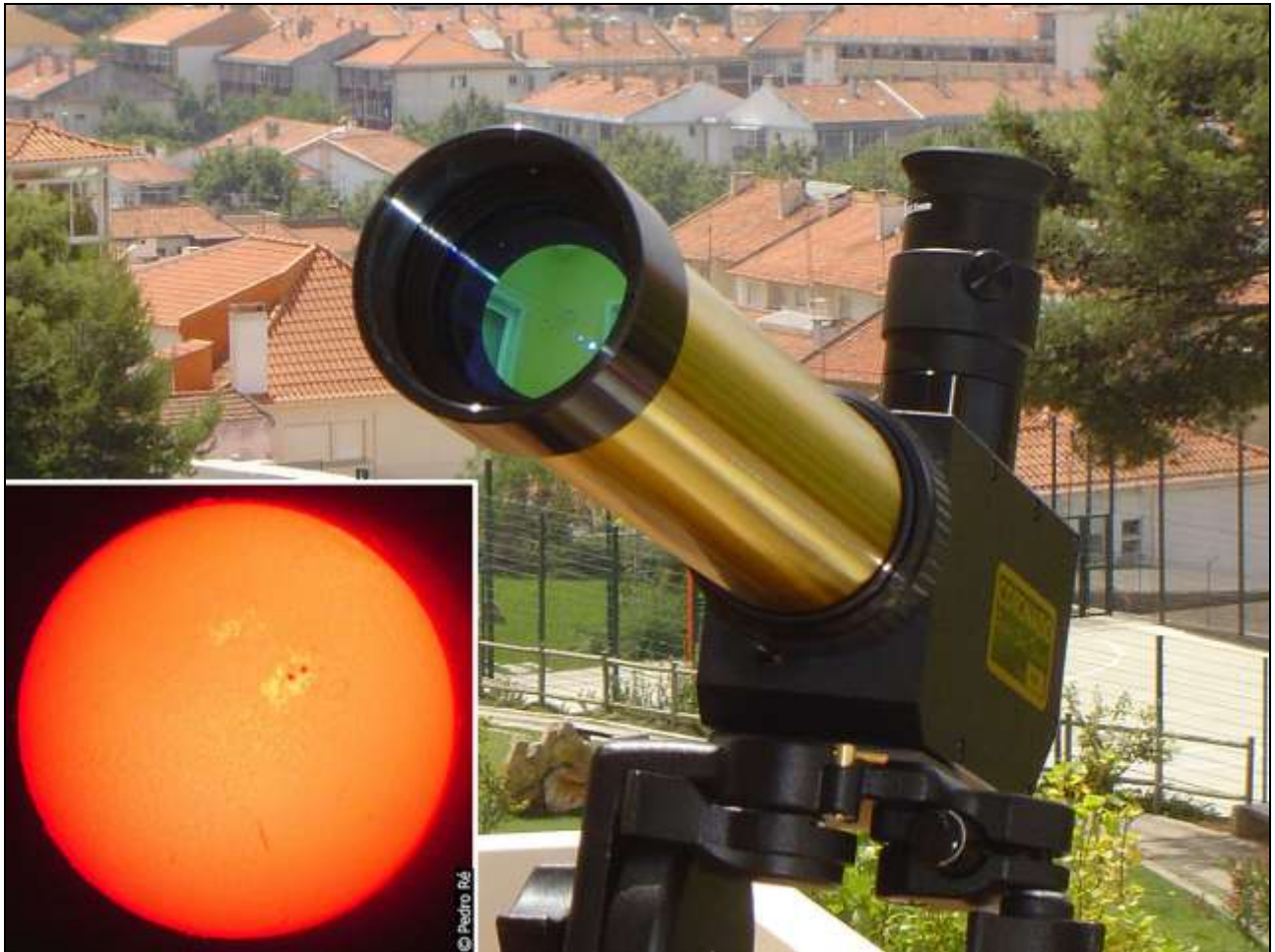
Figura 6- Imagem solar obtida em 20040725 com o auxílio de uma câmara Digital Sony P8 (método afocal). Pedro Ré (2004).
