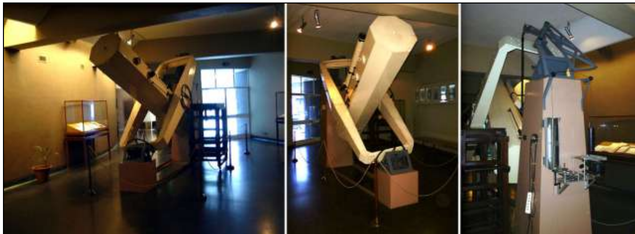
Figura 5- Telescópio de 500mm construído e utilizado pelo Comandante Conceição Silva actualmente em exposição permanente nas galerias do Planetário Calouste Gulbenkian.
