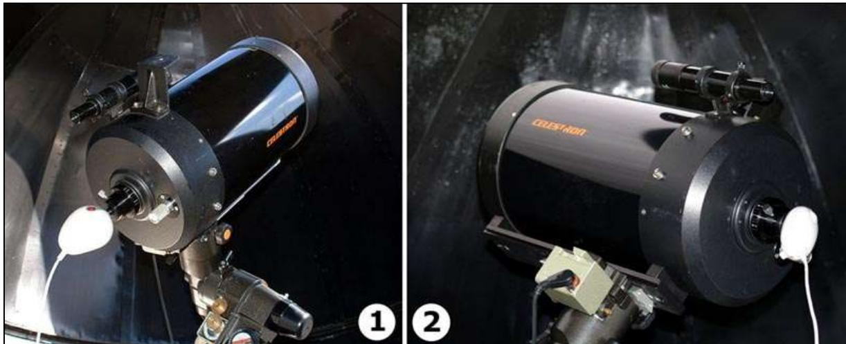
Figura 6- Duas *Webcams* adaptadas para astrofotografia. 1- *Philips Vesta Pro* e 2- *Toucam Pro*. Pedro Ré (2002).
