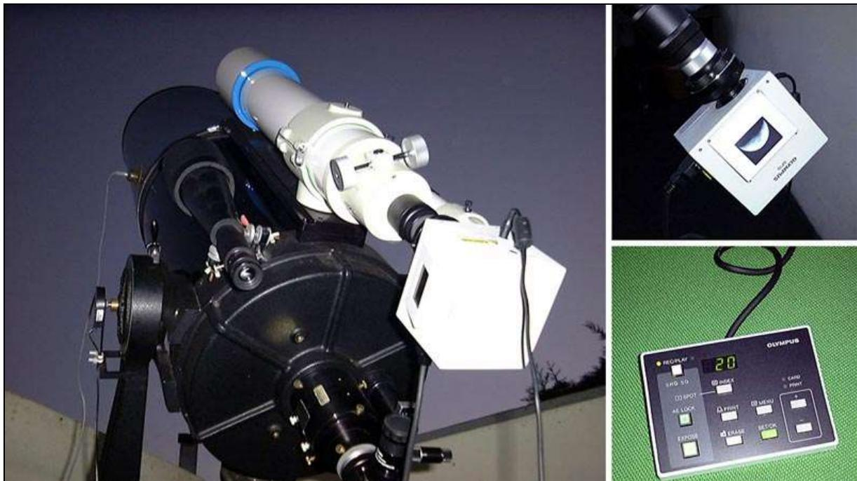
Figura 8- Câmara digital *Olympus* DP10 acoplada a um telescópio refractor apocromático *Takahashi* FS102. O visor LCD e a caixa de comando são visíveis na imagem (à direita na imagem). Pedro Ré (2001).
