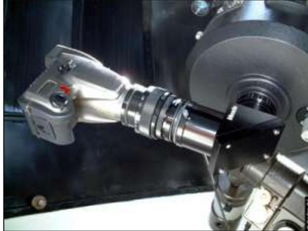
Figura 2- Sistema de projecção afocal. Telescópio Schmidt-Cassegrain 200 mm  $f/10$ , objectiva 80 mm 1:2.8 e *Olympus Camedia C-1400L*. Pedro Ré (2001).
