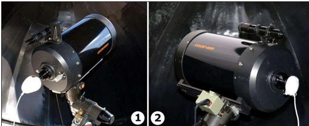
Figura 10- Duas *Webcams* adaptadas para astrofotografia. 1- *Philips* Vesta Pro e 2- Toucam Pro. Pedro Ré (2002).
