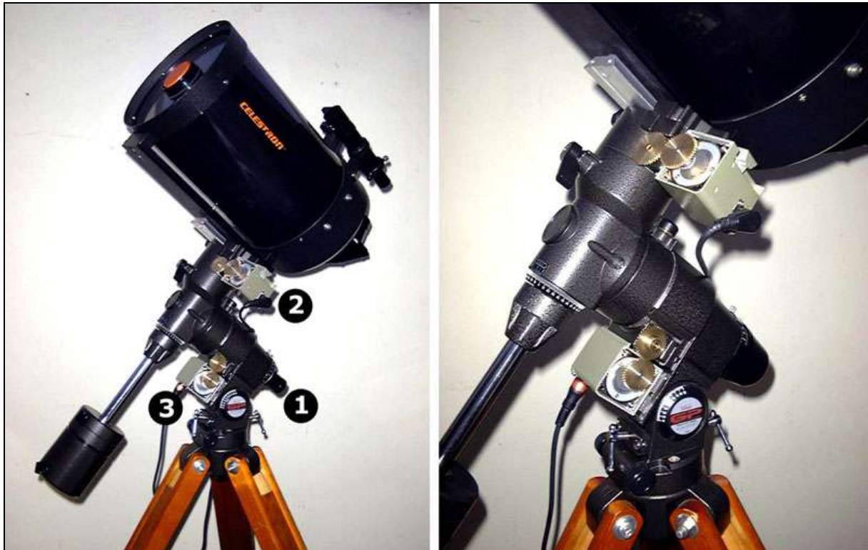
Figura 2- Montagem alemã Vixen GP , telescópio Schmidt-Cassegrain C8: 1- buscador polar; 2- motor de passos, eixo de declinação; 3- motor de passos, eixo de ascensão recta. Pedro Ré (2001).
