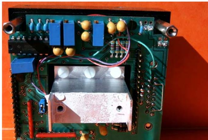
***Une caméra Audine ouverte, carte supérieure ôtée ; on distingue à gauche le capteur et son faisceau de fils. Le connecteur DB15 est à droite ; les fils rouges et mauve sont soudés sur les pattes du condensateur C4 ; le fil vert aboutit à la broche 15 du connecteur DB15 ; un pont connecte les broches 2 et 7 du connecteur DB15 (masses électronique et Peltier).***
