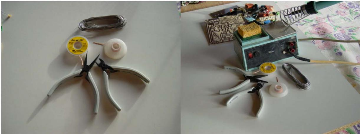
Pour ce qui concerne la soudure à l'étain, notez bien qu'il s'agit exclusivement de soudure de grade « électronique » : celle qui est utilisée dans les travaux de plomberie ne convient absolument pas.
