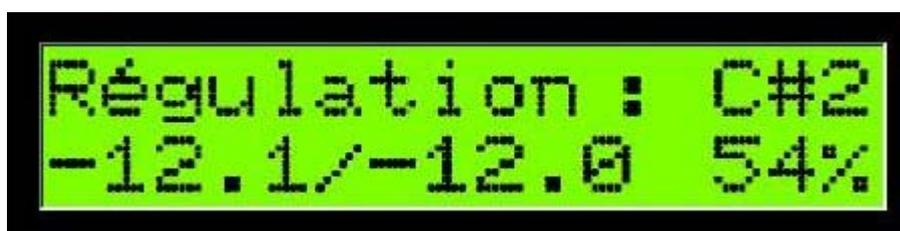
Ici, on voit que la température extérieure est de l'ordre de 20 degrés, que le module à effet Peltier a déjà refroidi le doigt froid à 17 degrés environ, et que la consigne en cours s'établit à -12 degrés ; le taux de refroidissement est de 100%, c'est à dire que le module à effet Peltier refroidit pour l'instant à fond.
