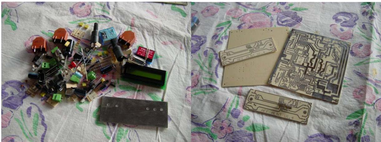
***L'ensemble des composants, le refroidisseur et les circuits imprimés***
