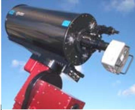
Figure 17 : Un instrument de type Ritchey-Chrétien pour l'amateur avancé.
