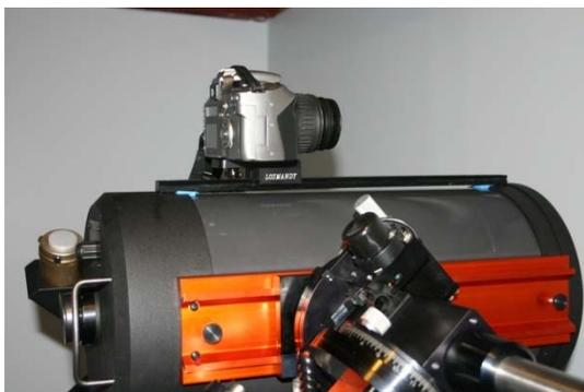
La technique de l'appareil monté en parallèle (en anglais : *Piggyback*) est la plus facile à mettre en œuvre. Dans sa forme la plus simple, il s'agit de fixer un appareil photo muni d'un objectif grand-angulaire sur le télescope ou sur une monture préalablement alignée, de démarrer le suivi et d'actionner le déclencheur. La plupart des fabricants d'accessoires
