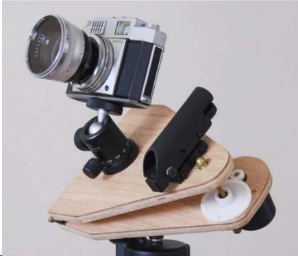
Figure 11 : Un appareil photo installé sur une table de Poncet.
