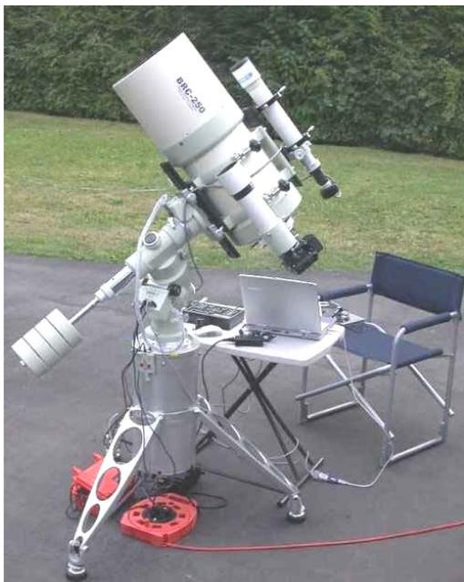
**Appareil photo dédié à l'astrophotographie** : ces instruments sont surtout de type panchromatique et utilisent des filtres à bande passante. Ils fonctionnent principalement sous 120 volts de tension et ont besoin d'être refroidis. Les fabricants les plus connus sont *SBIG*, *Atik*, *Yankee Robotics*, *QSI*, *Finger Lake Instruments*, *Apogee Instruments*. Gamme de prix :
