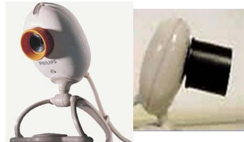
Figure 3 : La « *To-U-Cam* » et le tube d'adaptation au télescope.
