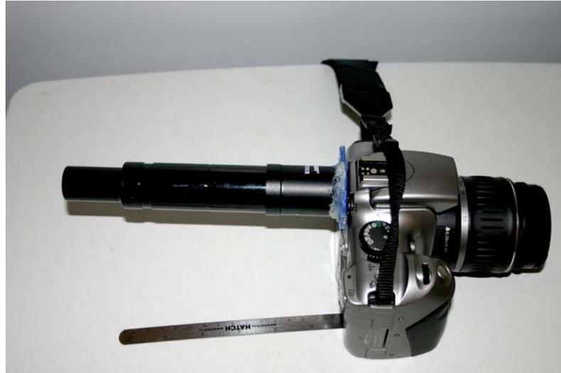
Figure 35 : Pour faire la mise au point d'un APN, on peut utiliser un viseur (ici un vieux cherche-étoile) que l'on adapte directement sur l'ocilleton.
