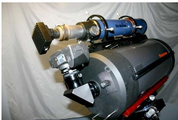
Figure 25 : Appareil photo monté au foyer primaire du télescope.
