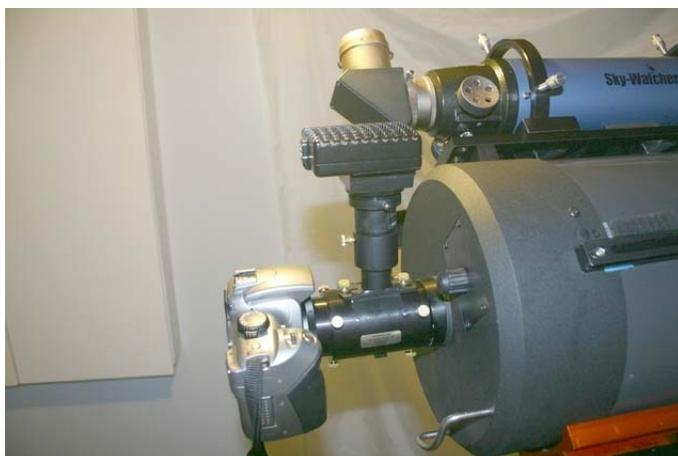
Figure 34 : Installation de l'appareil photo.
