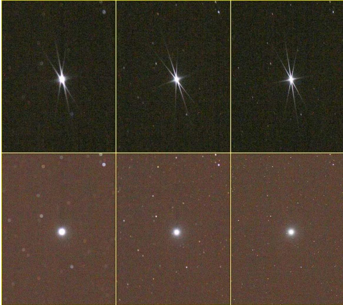
Figure 37 : Mise au point effectuée à l'aide du masque de Bahtinov. Le même champ d'étoiles est représenté dans une image hors foyer (à gauche) passant à une image parfaitement au point (à droite). L'aigrette centrale se déplace lorsqu'on tourne le bouton de mise au point et la mise au point parfaite est atteinte lorsque l'aigrette est centrée.
